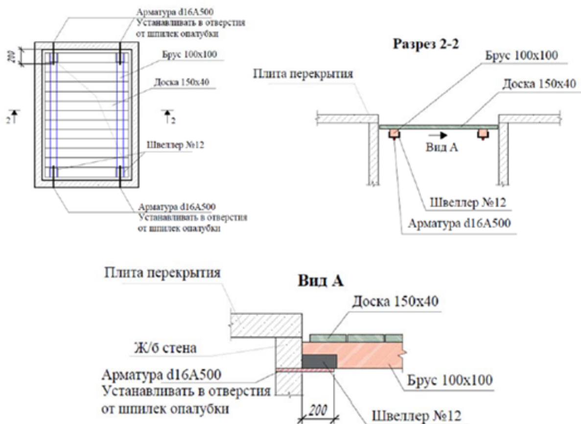
Рис. 19.2 Устройство временного настила в лифтовой шахте (а также в вентиляционной шахте)
