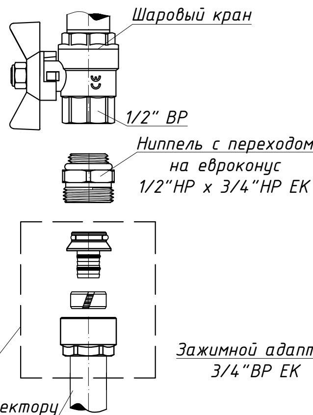
Присоединение трубы из сшитого полиэтилена к квартирному коллектору (5-8 кВт)
